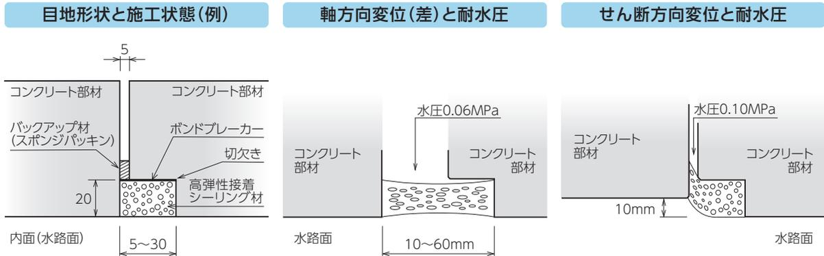
上記の水密性は、目地幅と同一の軸方向変位または10mmのせん断方向変位を360回繰り返し与えた後に、同変位を保持した条件で水圧を3分間作用させることによって確認しました。
