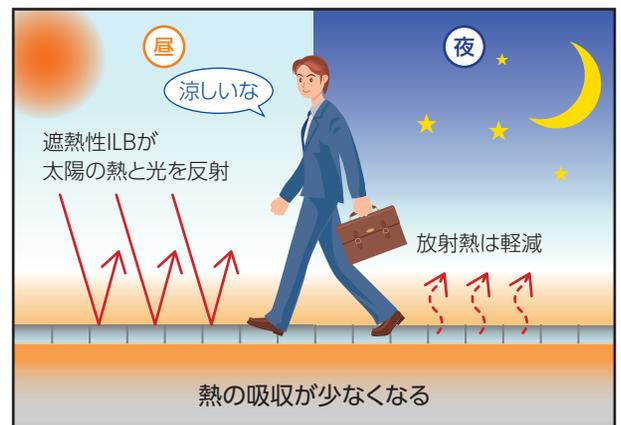
■ 舗装を暖める太陽光を反射し、表面温度を低減します。
